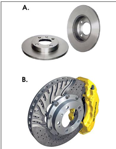
Los discos de freno son uno de los elementos de fricción en la acción de frenado de los sistemas de freno de disco. Suelen estar fabricados con acero aleado con cromo, ya que deben soportar elevadas temperaturas sin sufrir deformaciones.
